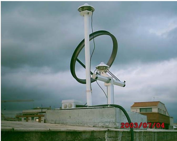
Piranòmetres, terrat ETSEIAT, c/ Colom
